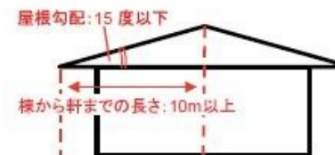
大スパン・緩勾配の屋根
